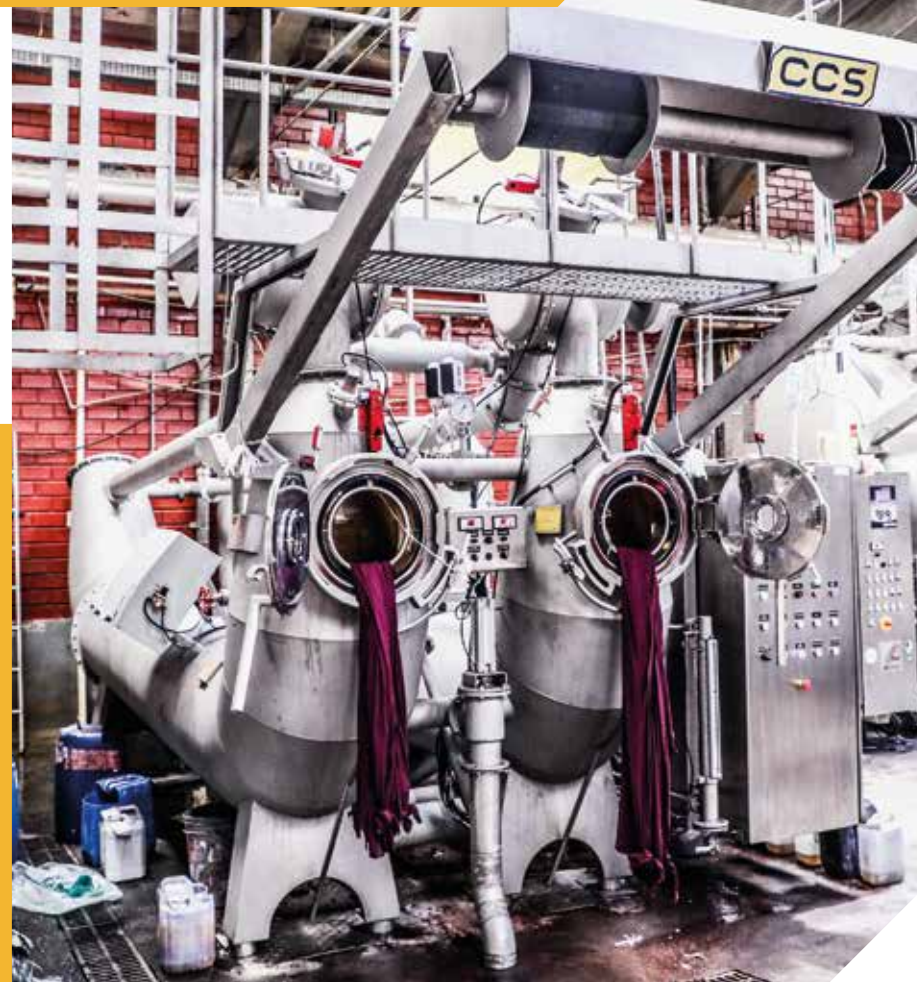
Foto: Modelo: LCS.3000 HT-JET Capacidade: 300 KG
